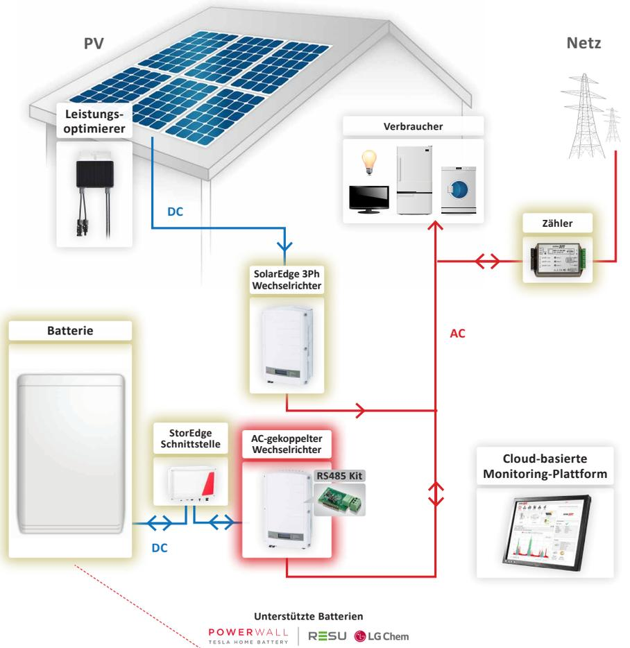
Hinweis: Der StorEdge AC-gekoppelte Wechselrichter von SolarEdge ist nicht für die Verwendung mit Leistungsoptimierern oder den Einsatz als Standard Wechselrichter geeignet
